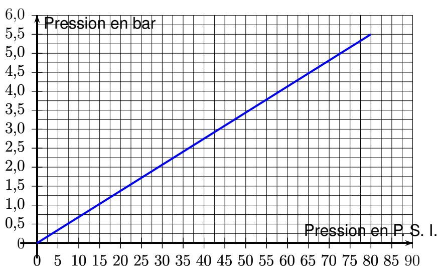
Avant de prendre la route, Léa vérifie la pression des pneus de sa voiture. La pression conseillée sur le manuel du véhicule est de 36 P.S.I.
