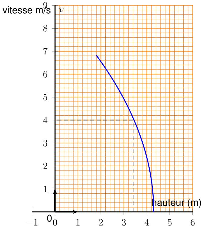
Par lecture graphique, la vitesse d'écoulement est de **4 m/s** lorsque la hauteur de l'eau dans l'écluse est de 3,4 m (voir les pointillés sur le graphique).
