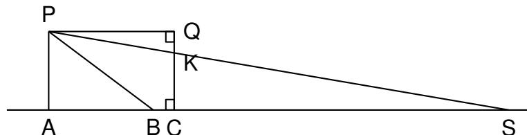
Pour que l'éclairage d'une voiture soit conforme, les constructeurs déterminent l'inclinaison du faisceau. Cette inclinaison correspond au rapport  $\frac{QK}{QP}$ . Elle est correcte si ce rapport est compris entre 0,01 et 0,015.
