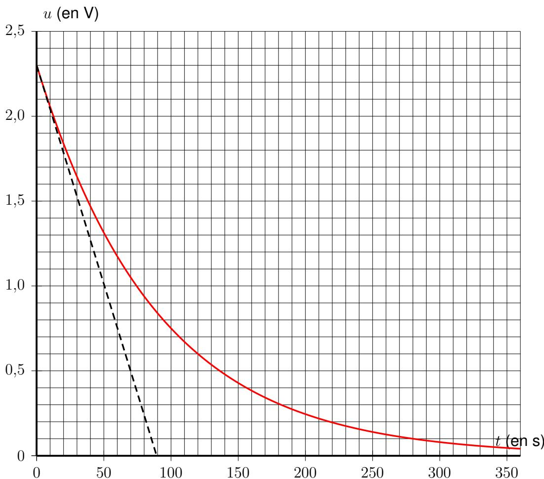
L'évolution de la tension aux bornes du supercondensateur est modélisée par la fonction  $f$  définie sur l'intervalle  $[0 ; +\infty[$  par:
